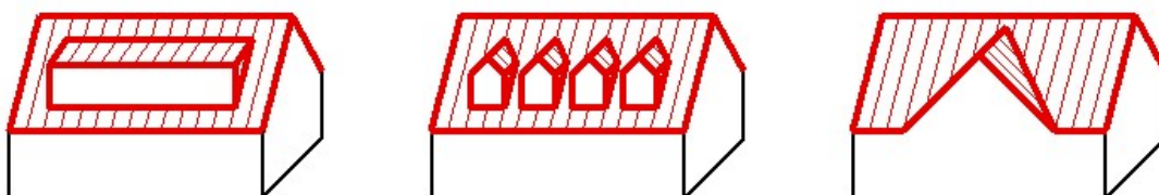
obr. 3 – příklad nevhodných způsobů osvětlení podkroví – axonometrie
